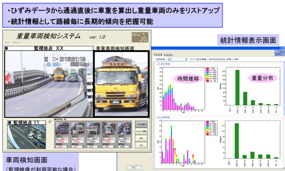
図表 II-18 BRIMOS の車両検知システム画面イメージ
