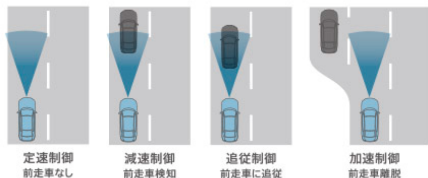
図 30 ACC (車速/車間制御機能) の基本制御パターン概念 22
