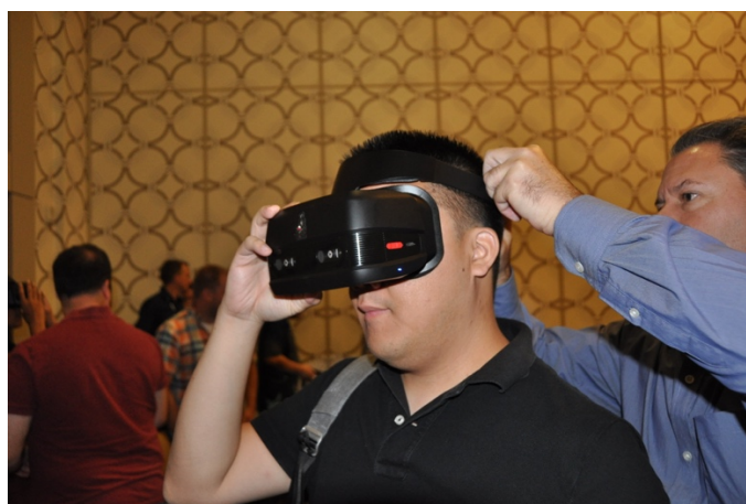
図表2-10：VR（仮想現実）／AR（拡張現実）用HMD（Head Mounted Display）の例。これはスマートフォン用半導体を使ってHMDを開発するためのリファレンスモデル（出所 米Qualcomm 記者説明会、2017年7月）
