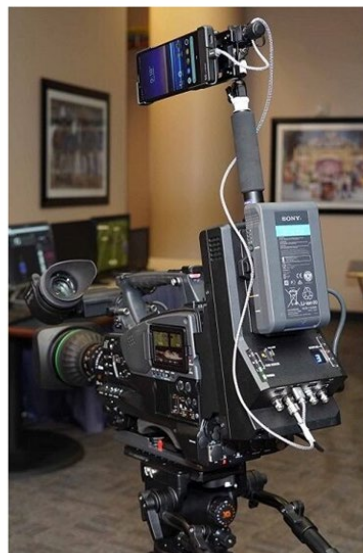
ショルダーカムコーダー『PXW-Z450』にトランスミッター試作機、Xperia 5Gミリ波帯対応デバイスを搭載したカメラシステム
