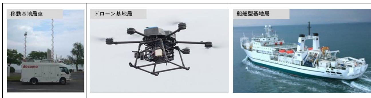
図表 3-108 携帯電話各社が導入あるいは開発中の臨時基地局
