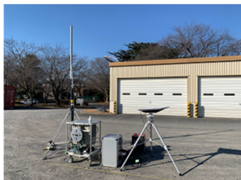
図 4-8 Starlink をバックホール回線として利用した車載型基地局 (左) と可搬型基地局 (右)
