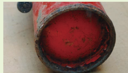
長い間放置され腐食の進んだ消火器
