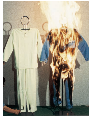
防災品と非防災品 (パジャマ)の比較燃焼実験 [同時着火1分経過の状況]
