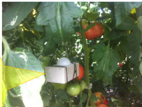
計測機器を植物群落ごとに設置し、リアルタイムにLAIを測定
