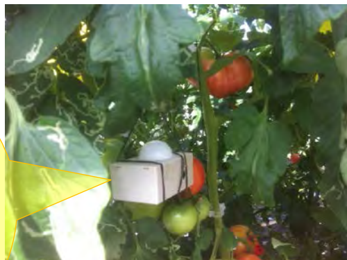
計測機器を植物群落ごとに設置し、リアルタイムにLAIを測定
