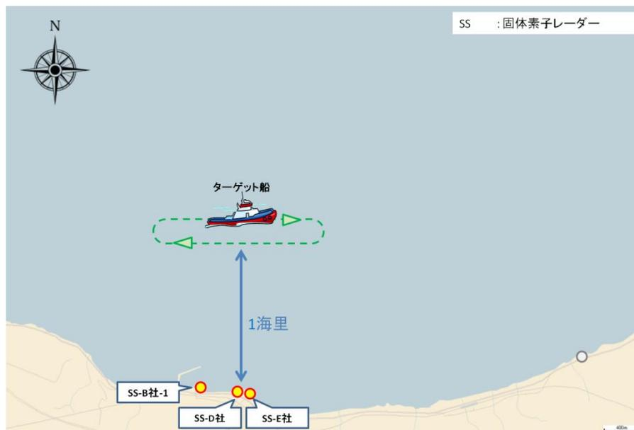
図 3.6-1 固体素子レーダー相互の干渉における配置（実験6 項目1~3）
