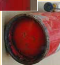
長い間放置され腐食の進んだ消火器
