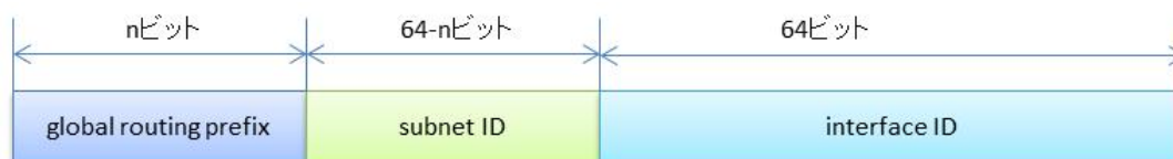
図 5-2 IPv6 グローバルユニキャストアドレスの構造
