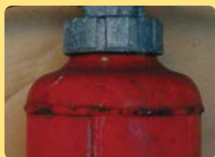
長い間放置され 腐蝕の進んだ 消火器
