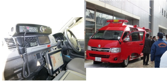
デジタル消防・救急無線設備
