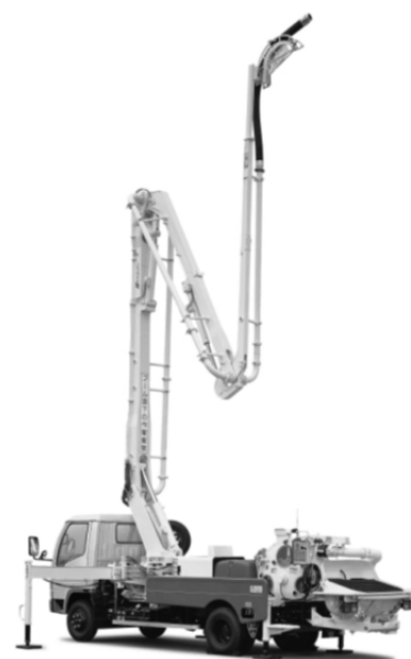
図 21 コンクリートポンプ車
