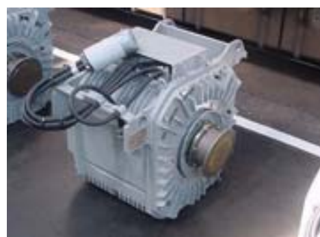
図 2.5 全密閉式主電動機 (小田急電鉄環境報告書 2012 より)
