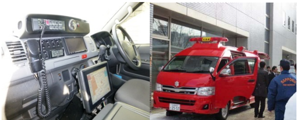
デジタル消防・救急無線設備
