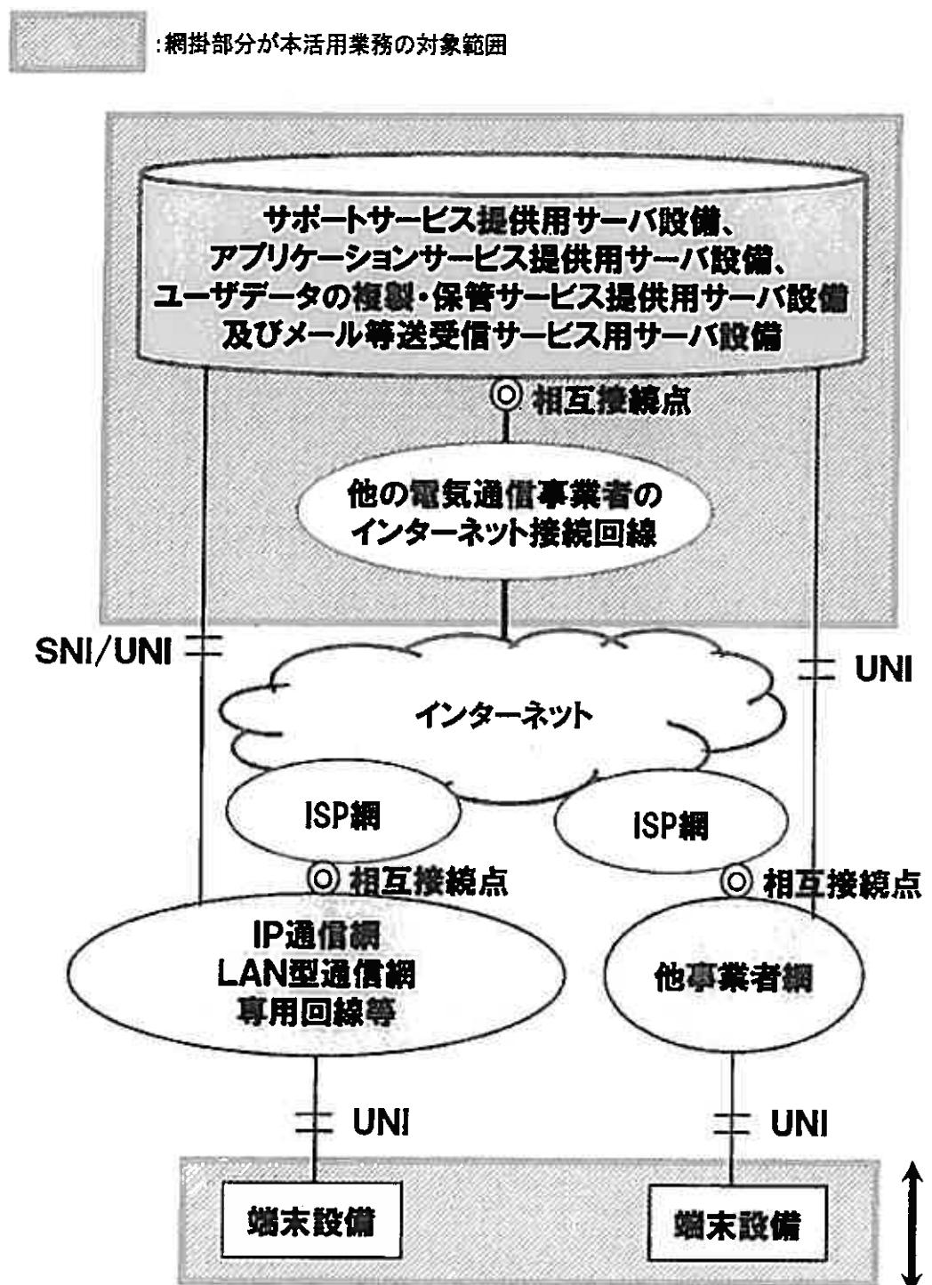
※当社サーバ設備は必要に応じて次世代ネットワークのSNI及びインターネット接続回線を介してインターネットに接続
