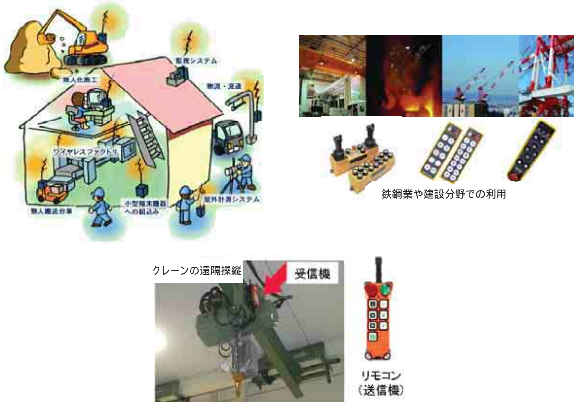
図 3-5 テレコントロールの利用例
