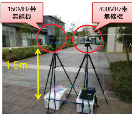
図4-6 試験設置風景(送信局)
