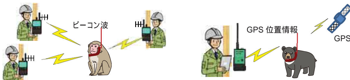
図 2-3 動物の現在位置を把握するシステムのイメージ（リアルタイムデータ）
