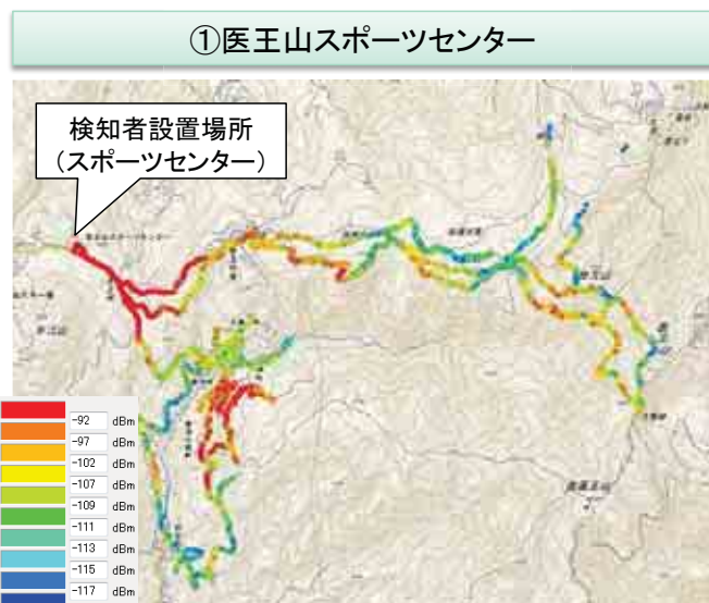
医王山スポーツセンターに設置した検知者端末における登山者端末からの受信電力マップ
