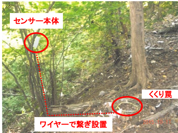
くくり罠に繋げて設置した捕獲センサー
