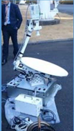
自動捕捉型可搬局 (三菱電機製)
