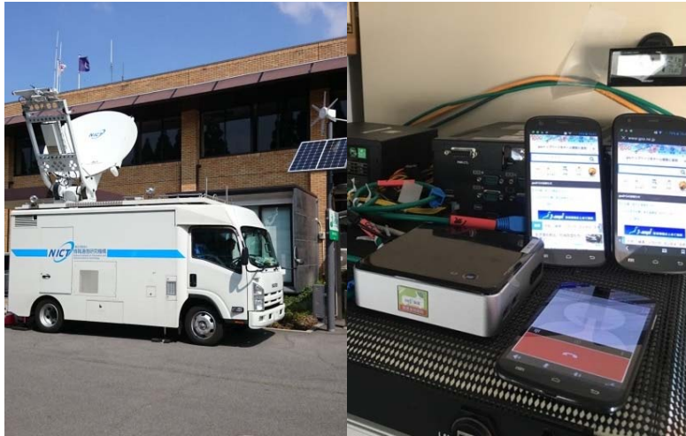
NICT車載衛星地球局※×ICTユニット
