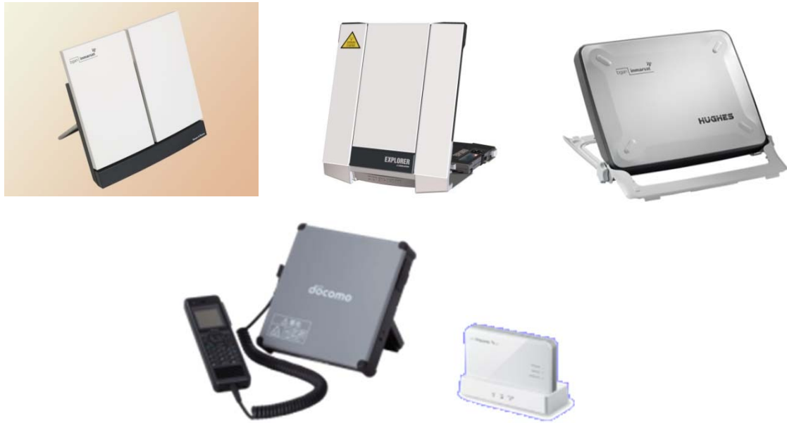
写真：衛星データ通信（低速～中速）の可搬型の通信端末例
