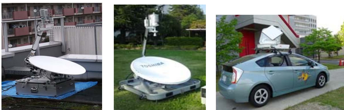
図：V S A Tの衛星データ通信端末の例（可搬型と車載型（右））
