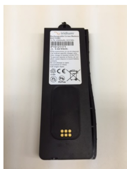
写真：衛星携帯電話で用いられるバッテリー
