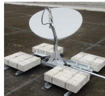
VSATの衛星データ通信端末の例 (左から固定設置型、可搬型、車載型)
