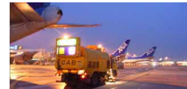
(舗装面清掃:航空機エンジンへの吸い込みを防止するために、路面の異物や土砂等を回収・処分)
