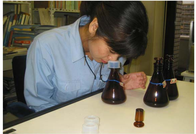
図-9 三点比較式フラスコ法
