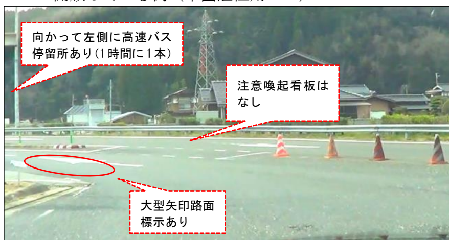
図表15 高速バスが転回するために料金所プラザ内の一部を開放している例(中国道佐用IC)
