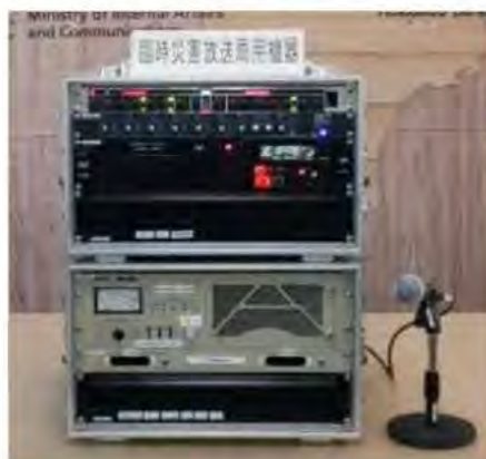
当局が保有している臨時災害放送局設備 (この他に送信アンテナが付属します)
