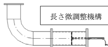
長さ微調整機構 空気圧縮機吸気配管に設置、16 Hz の卓越成分を 15 dB 程度低減
