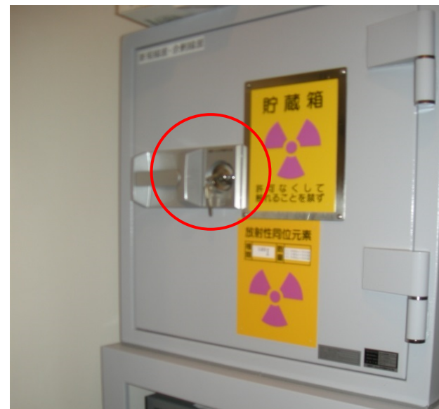
貯蔵庫の扉が施錠されておらず、また、鍵が差し込まれたままの状態
