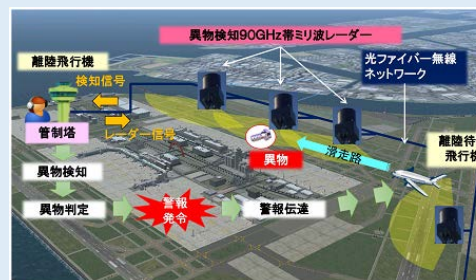
滑走路面異物検知システム
