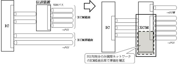
図2-4 実際ネットワークと提案されたモデルへの適用方法
