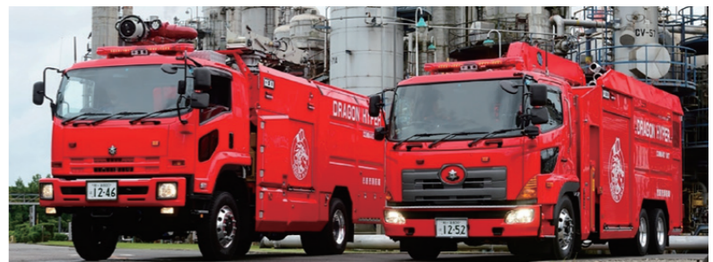
「スクラムフォース」と行動をともにするドラゴンハイパー・コマンドユニットの中核車両放水砲搭載ホース延長車(左)と大容量送水ポンプ車(右)
