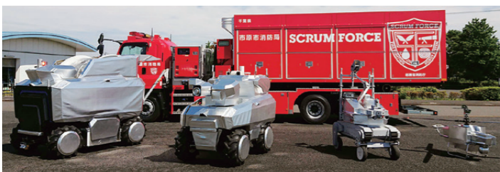
消防ロボットシステムとその搬送車輛
