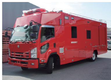
特殊災害対応自動車 (NBC対応資機材を積載し、陽圧室を有する)
