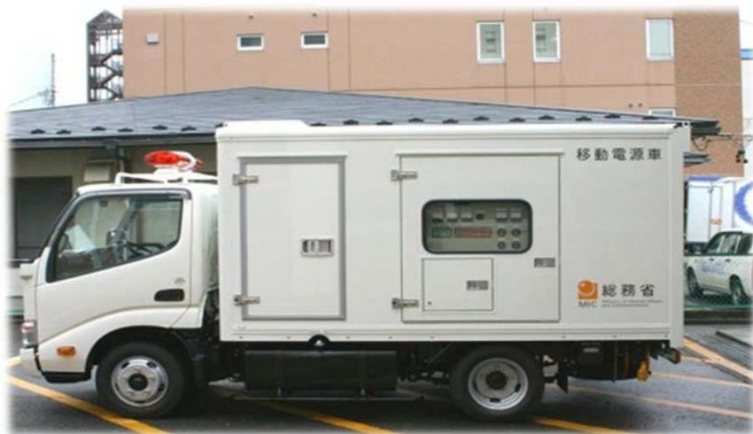
出力:100kVA(最大負荷時満タンで約6時間稼働)
