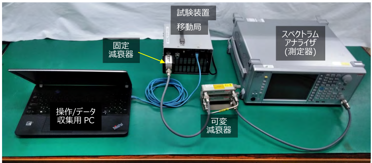
図 2-7 送信スペクトラム特性試験における試験構成外観写真
