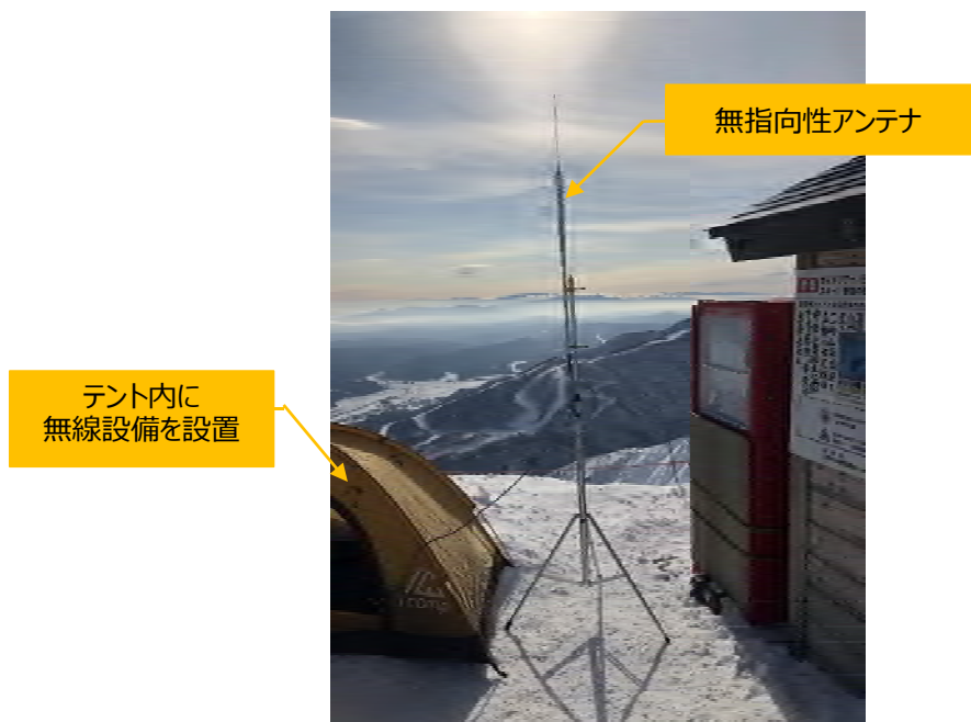
図 2 -52 山岳高所側の無線設備及び送信用無指向性アンテナ（積雪期）
