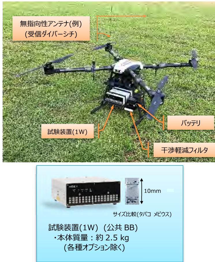
図 A13-1 ドローンに搭載する公共 BB 試験装置及び無線設備
