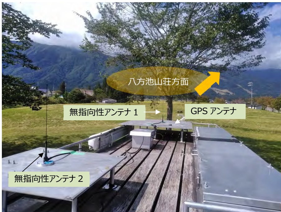
図 2-56 車両ルーフに設置したアンテナ（ダイバーシチ(2 ブランチ)）（無積雪期）
