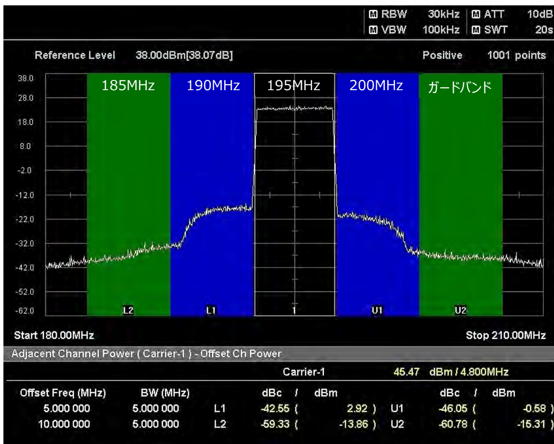
図 2 -12 隣接チャンネル／次隣接チャンネル漏えい電力 (5W)
