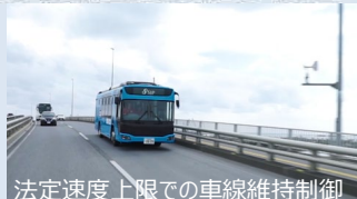
法定速度上限での車線維持制御 (S字、強風、勾配等)
