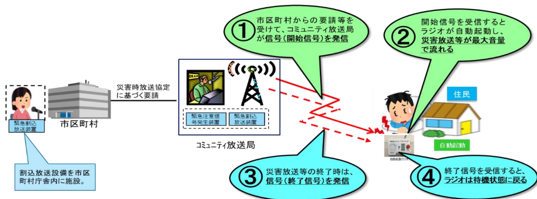
図表 16 自動起動ラジオの仕組み
