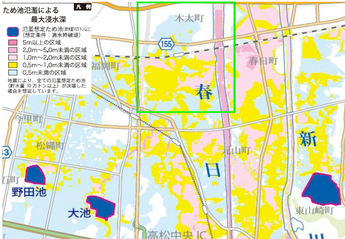
図表 2-(2)-㉒ 高松市木太地区のため池氾濫による浸水深
