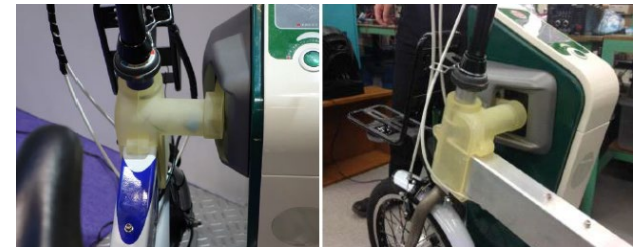
→ 非接触給電の給電部分 /出典：㈱ベルニクス提供資料
