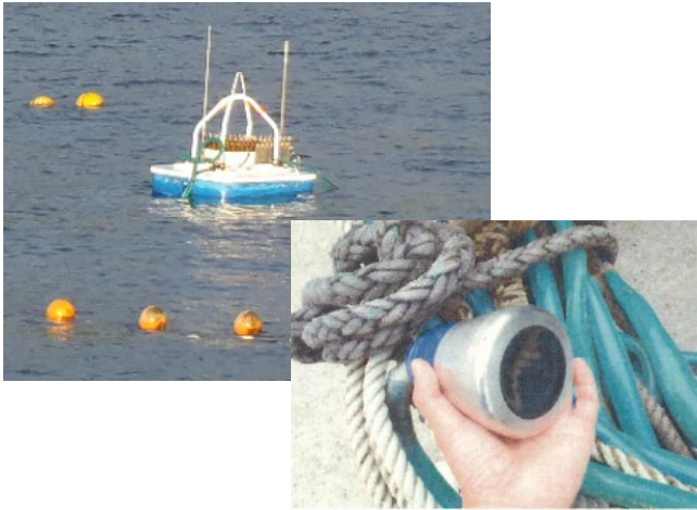
定置網用の魚群探知機（左）、定置網内に吊り下げる送受波器（右）／出典：公立はこだて未来大学の提供資料
