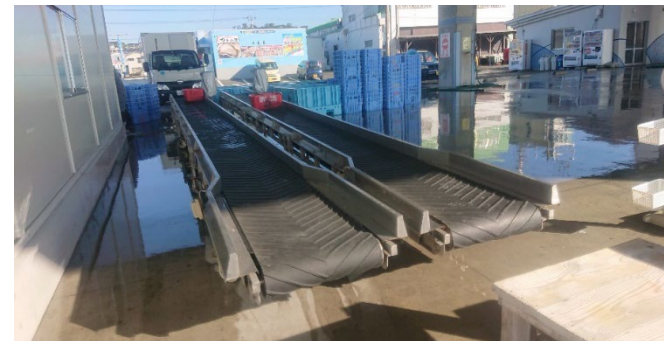
カゴを運搬するベルトコンベア
