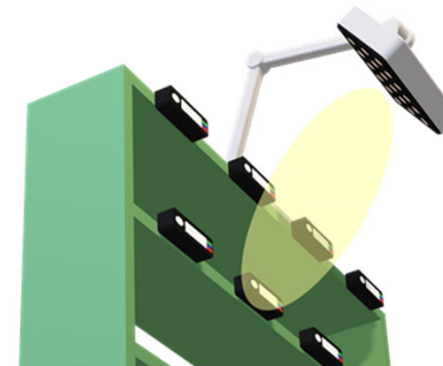
(b)倉庫等のピッキング表示器
