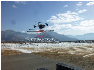
アンテナ設置状況
