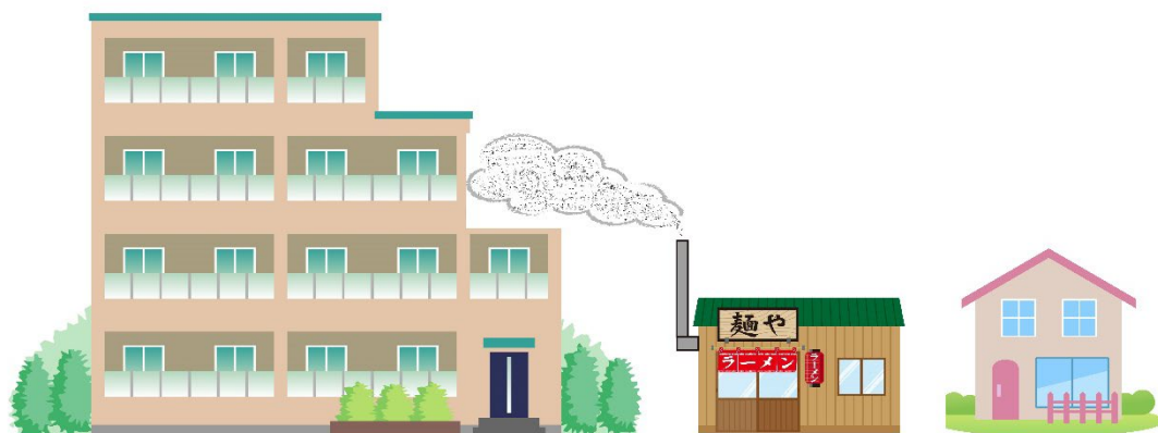
図5 排気口延長に向かない場合の例
