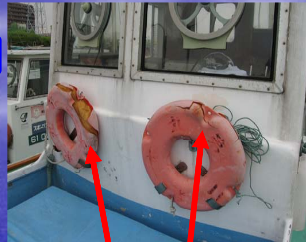
救命浮環に亀裂
