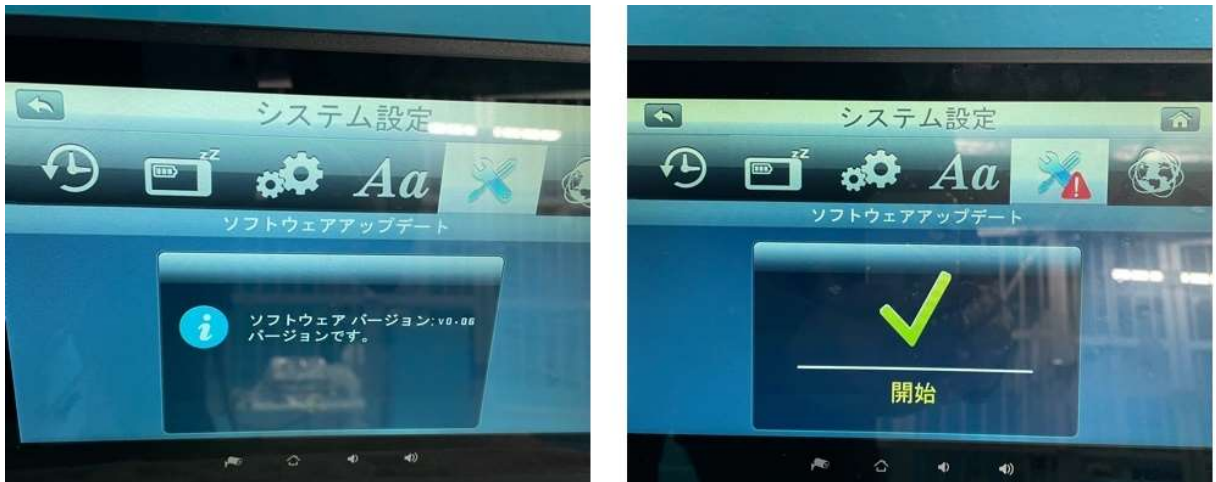
図 5.2.6-17 既存ネットワークカメラのソフトウェアアップデート (左:ネットワーク未接続、右:ネットワーク接続後)
