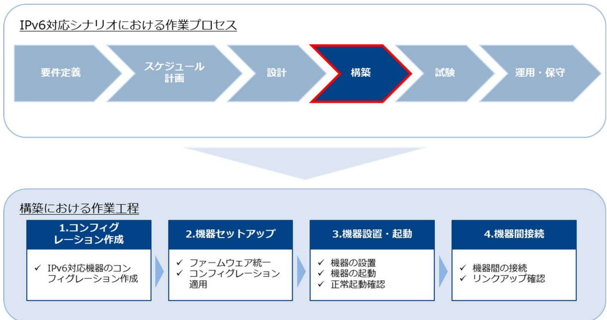
図 4.4-1 構築作業の工程イメージ
