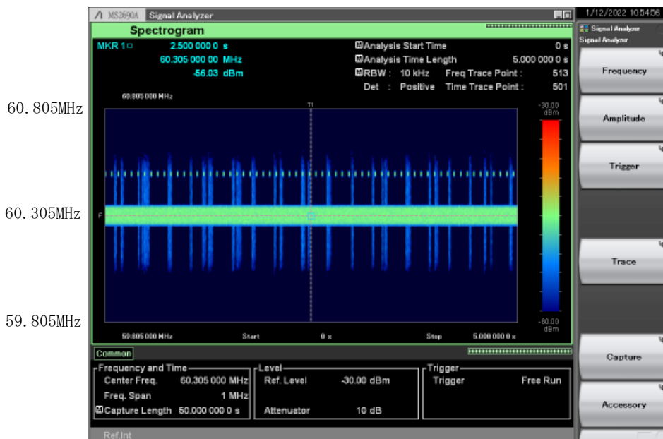
図 5.4-16 外来雑音受信時の信号解析波形 2 (スペクトログラム(解析時間 5 秒)、高ボッチ局、測定日:令和3年9月22日)
