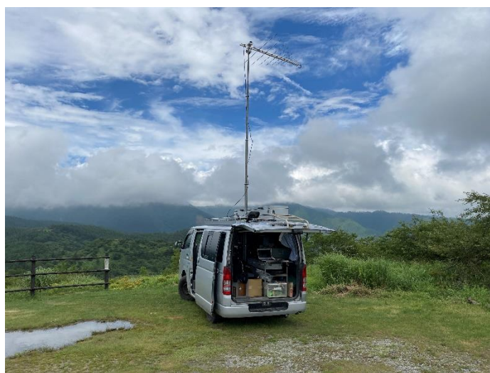
図 5.4-29 外来雑音測定風景(高ボッチ局の局舎近傍)
