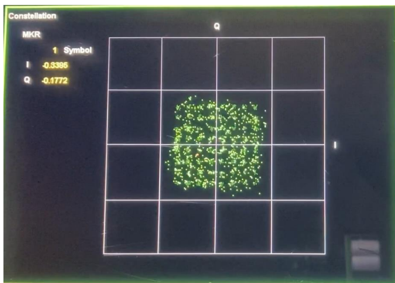
図 5.4-17 外来雑音受信時の信号解析波形 3 (コンスタレーション波形、高ボッチ局、測定日:令和3年9月22日)
