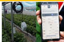
【環境制御機器によるビニールハウス内温度・湿度、CO2濃度等の自動管理】
