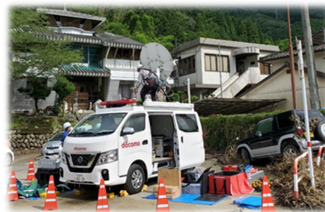
衛星エントランス搭載移動基地局車
