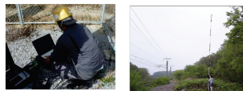
事前測定(電波レベル、品質、電波到来方向等)
