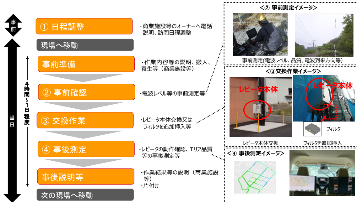
図表 20: 高出力レピータの作業工程
