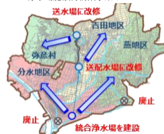
浄水場施設再構築事業イメージ
